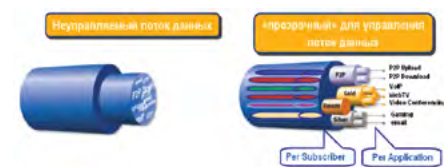
Рис. 3 Грануляция потока данных с помощью DPI
