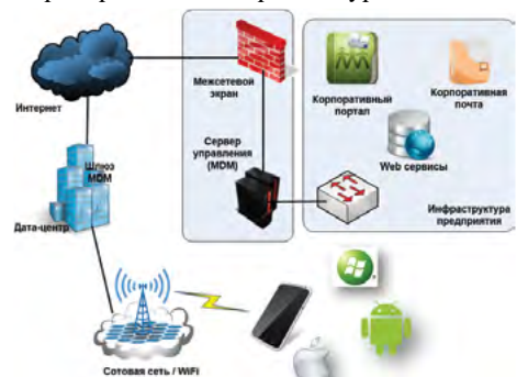
Рис. 3 Централизованная архитектура управления мобильными устройствами
